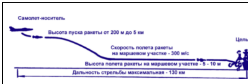
Схема боевого использования ракеты X-35 с самолета-носителя
