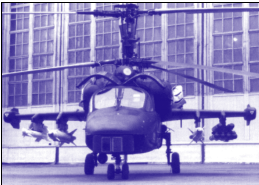
Авиационные ракеты: Р-73, две Х-25МЛ и шесть ПТУР "Вихрь" на подвеске боевого вертолета Ка-52 (слева направо)
