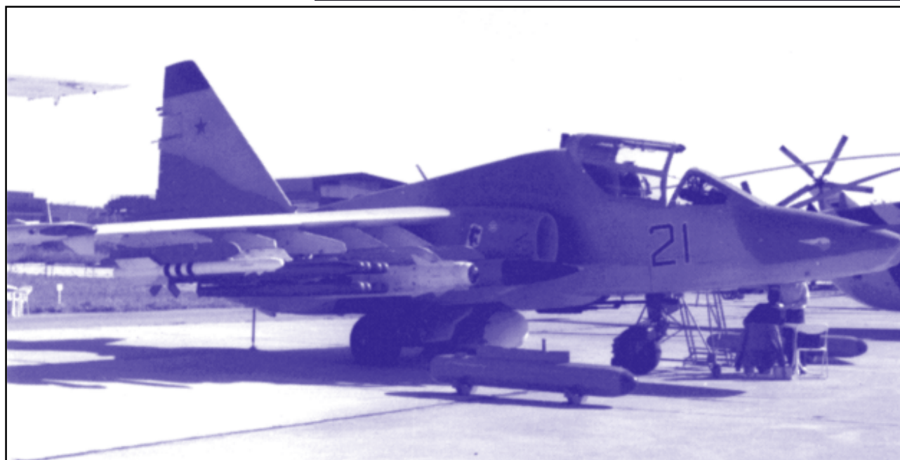
Пусковая установка АПУ-8 с транспортно-пусковыми контейнерами ракет "Вихрь" под крылом штурмовика Су-39
