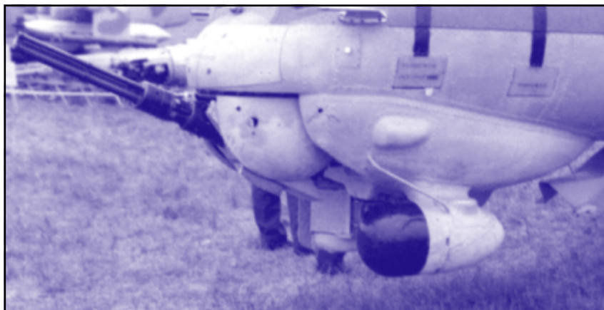
Тепловизионный канал системы наведения "Радуга-3"
