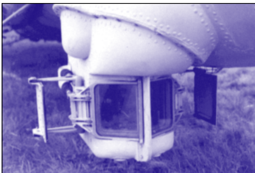
Оптический канал системы наведения "Радуга-III"
